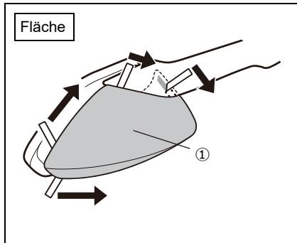
7. Ziehen Sie das gesamte Trägerpapier der 4 doppelseitigen Klebebander ab, die wie in der Abbildung gezeigt auf die Oberfläche geklebt wurden.
