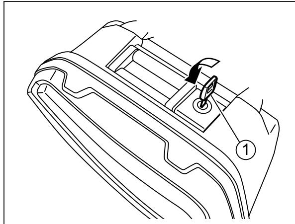
2. Relever le levier de verrouillage ① et ouvrir le couvercle de la valise.
