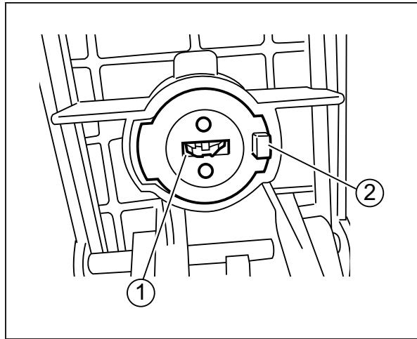
4. Appliquer du frein-filet sur les vis TORX® ① et installer la plaque de verrouillage ② en serrant les vis.
