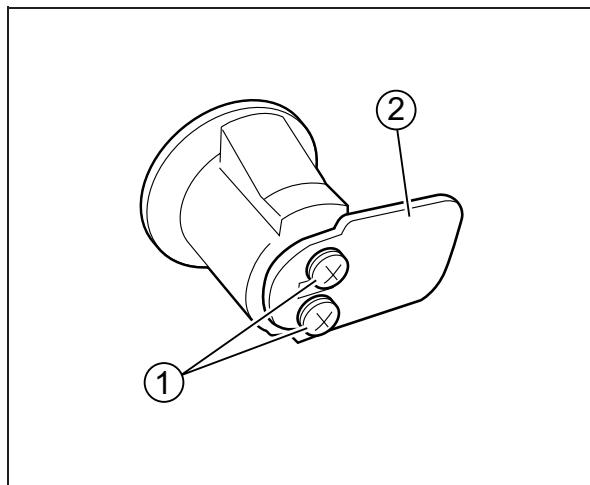
2. Inserte el cilindro de llave en el orificio ① del portaequipajes lateral.
