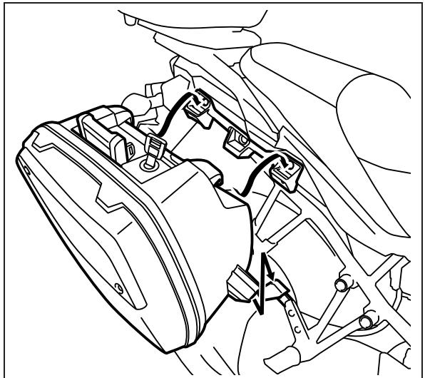
8. Piegare la maniglia verso il basso e verificare che la barra di bloccaggio ① sia inserita nella fessura della staffa superiore del portapacchi laterale.
