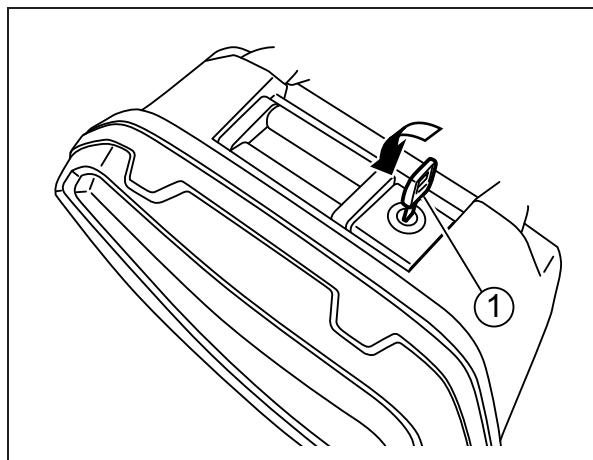
2. Sollevare la leva di bloccaggio ① e aprire il coperchio del portapacchi laterale.
