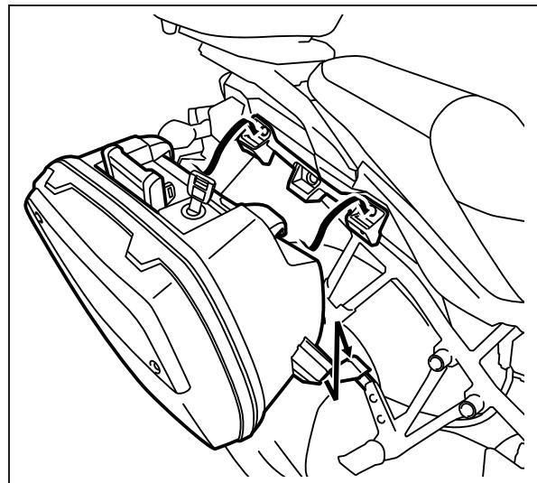
8. ハンドルを折りたたみ、バー①がサイドケースアップブラケットの溝に固定されていることを確認します。
