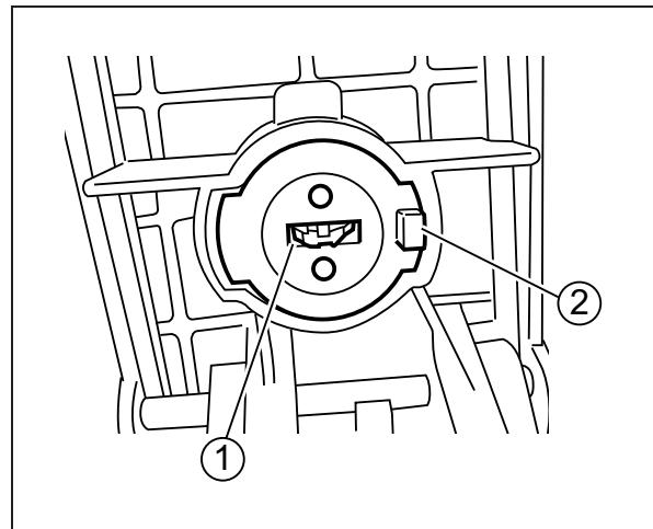
4. Schraubensicherungspaste auf die TORX®-Schrauben ① auftragen und mit den Schrauben die Schlossplatte ② anbringen.
