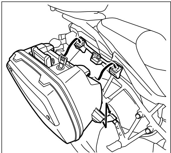
8. Pliegue el asa y asegúrese de que la barra de bloqueo ① encaja en la ranura del soporte superior del portaequipajes lateral.
