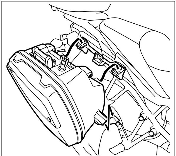
8. Abaisser la poignée et vérifier que la barre de verrouillage ① est engagée dans la fente du support supérieur de la valise.
