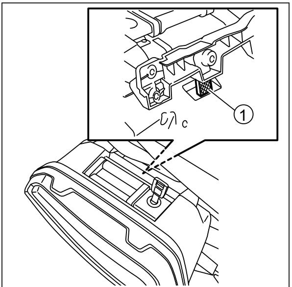
9. Den Griff und Verriegelungshebel völlig senken und den Koffer durch Drehen des Schlüssels verriegeln.
