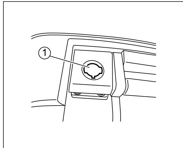
3. Den Schlüssel einstecken und drehen, bis das Schlüsselloch ① wie abgebildet mit dem Vorsprung ② fluchtet.
